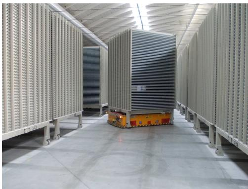
*Figura 14 - Veicolo a guida automatica per il trasporto interno delle piastrelle*
