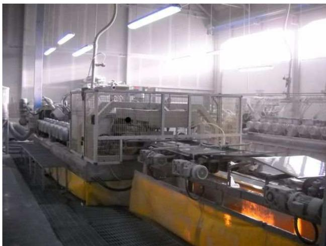
*Figura 10 - Linea di levigatura dello stabilimento di Dinazzano*
