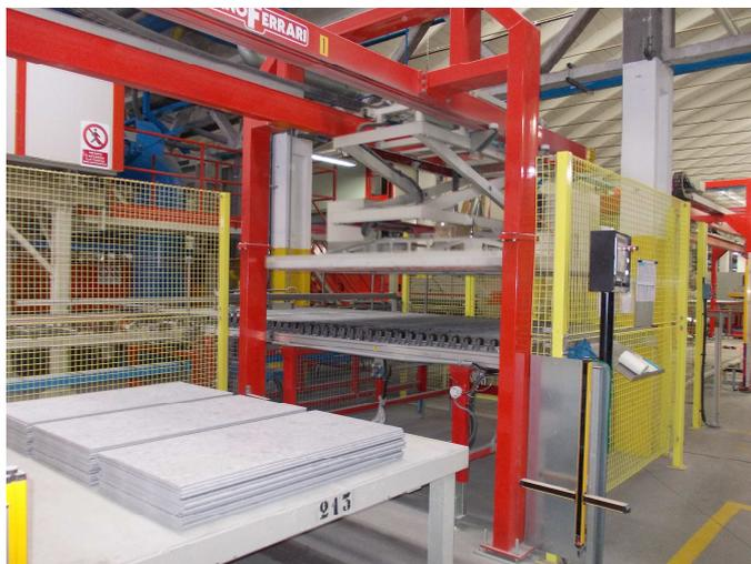
*Figura 8 - Carico/scarico piastrelle*
