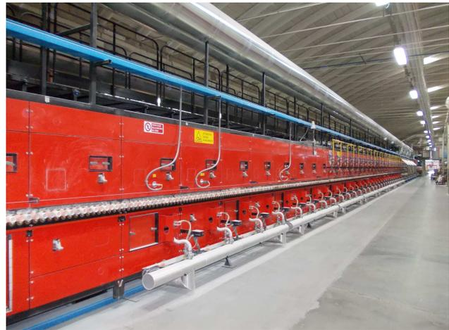
*Figura 7 - Forni di cottura delle piastrelle*
