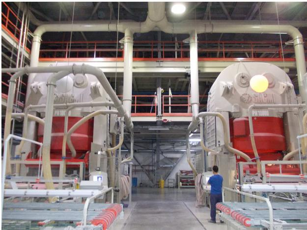
*Figura 6 - Impianto pressatura*
