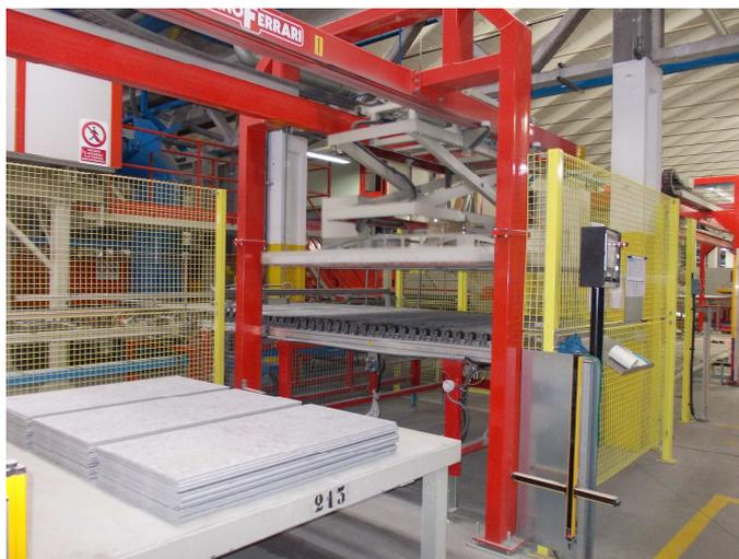
*Figura 8 - Carico/scarico piastrelle*
