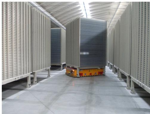
*Figura 14 - Veicolo a guida automatica per il trasporto interno delle piastrelle*
