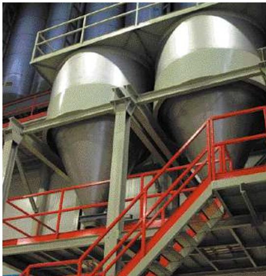
*Figura 5 - Silos contenenti atomizzato*
